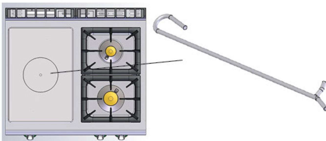
Pour contrôler visuellement la flamme du brûleur pilote, retirez la plaque centrale à l'aide du crochet prévu à cet effet.
